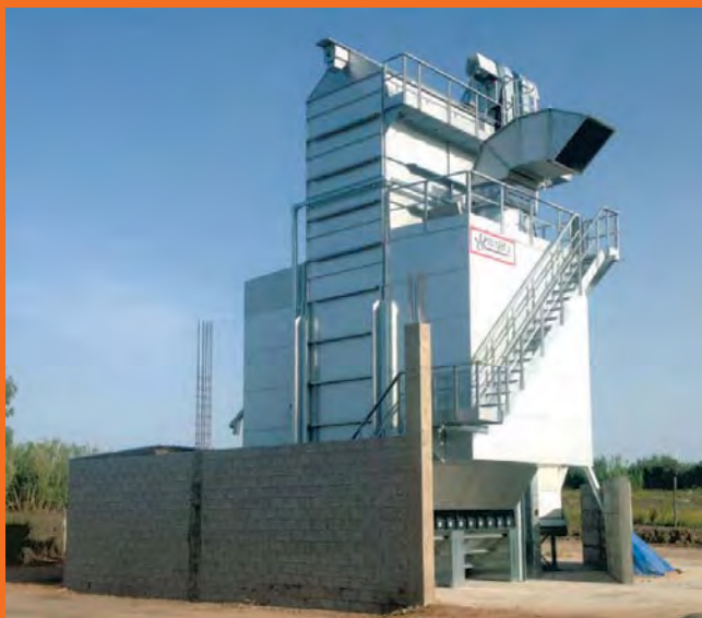
Essiccatoio pneumatico antipolvere 4 RR 5/5 BPN con passaggio secco (Santagiusta Sardegna)
