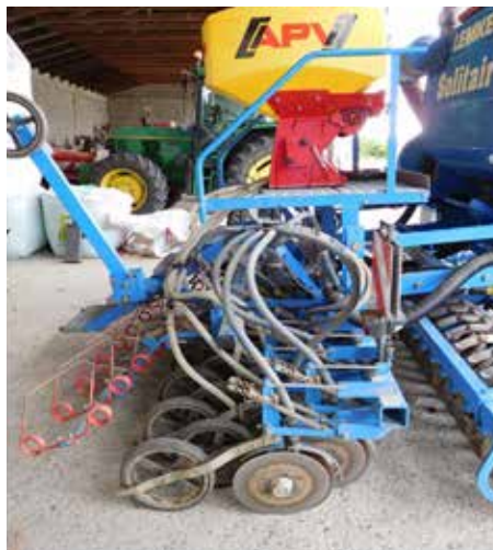
Lemken Solitaire con tramoggia e tubi distributori fertilizzante
