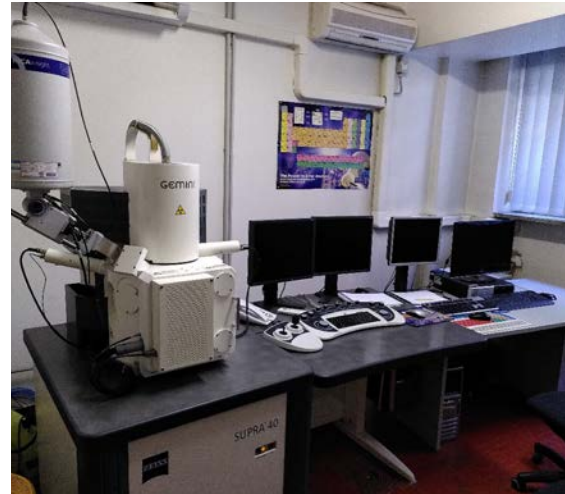
FESEM utilizzato per lo studio presso il Politecnico di Torino (Zeiss SUPRA 40 (Zeiss SMT, Oberkochen, Germany))
