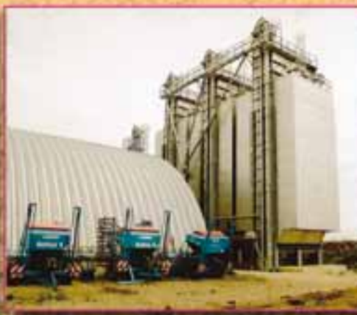
IMPIANTO DI ESSICCAZIONE PNEUMATICO ANTIPOLVERE 850 A CICLO DA TON 240
