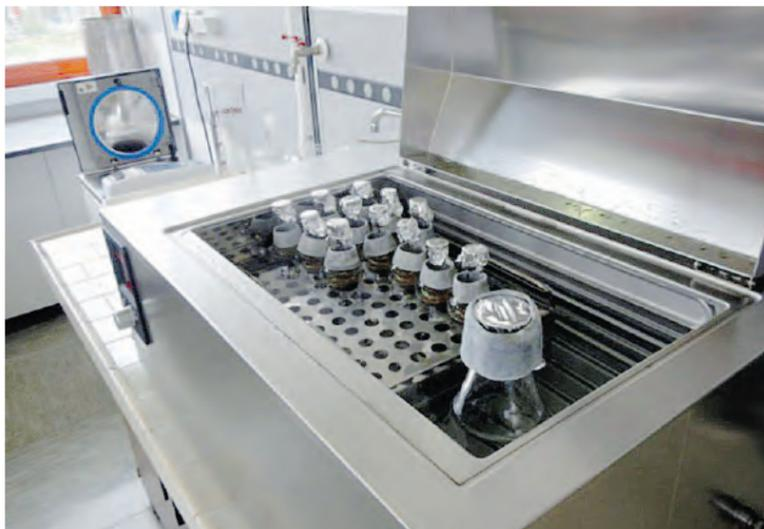
A sinistra, particolare del bagno termostatico ad acqua utilizzato per determinare la quantità di acqua assorbita dal grano delle singole varietà di riso
