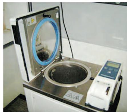
Autoclave impiegata per trattare con vapore sotto pressione il risone precedentemente macerato in acqua
