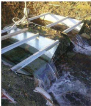
Figura 3 - Coppia di misuratori MRT120 installati in uscita all'unità aziendale U1
