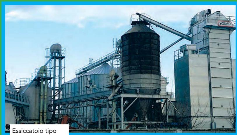
Essiccatoio tipo pneumatico-volumetrico antipolvere
