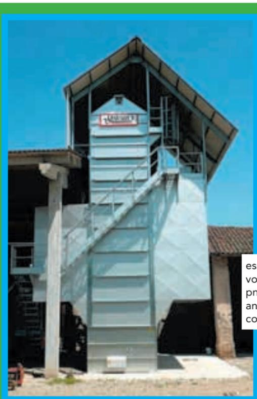
essiccatoio volumetrico pneumatico antipolvere con copertura
