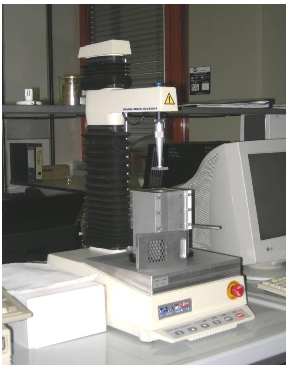
Figura 5 – Strumento per la determinazione della consistenza su un riso cotto
