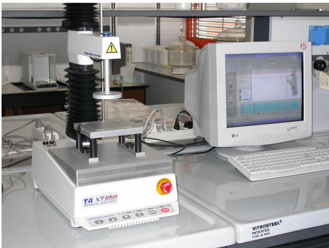
Figura 7 – Strumento per la determinazione della collosità su un riso cotto
