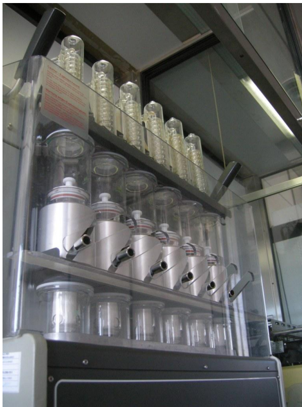
Figura 13 – Nuovo sistema automatizzato per estrazione dei lipidi secondo Soxhlet
