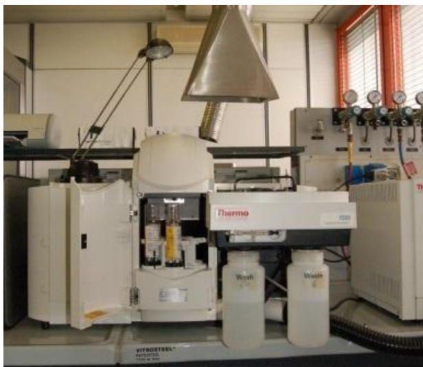
Figura 26 - Spettrofotometro ad assorbimento atomico con fornetto di grafite (GF-AAS)
