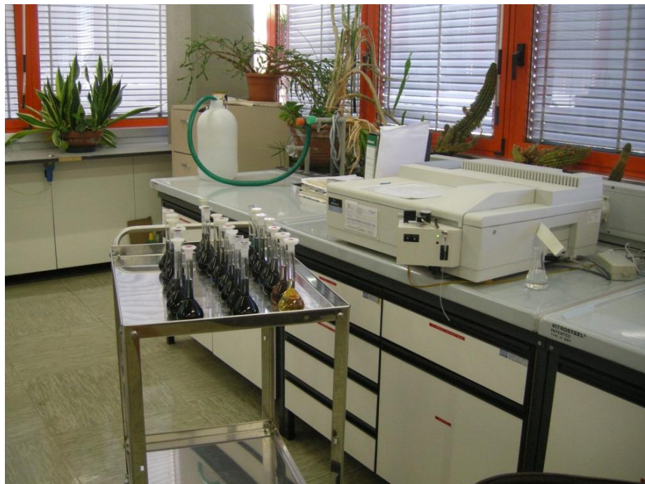
Figura 4 – spettrofotometro UV-VIS utilizzato nella determinazione dell'amilosio
