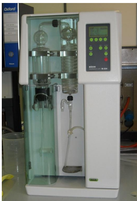
Figura 11 – Apparecchio per distillazione kjeldahl
