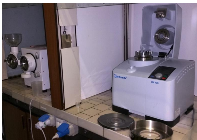
Figura 17 – Sistema di macinazione del laboratorio
