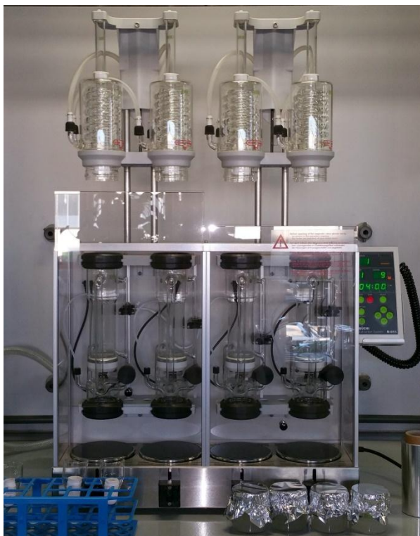
Figura 13 – Nuovo sistema automatizzato per estrazione dei lipidi secondo Soxhlet
