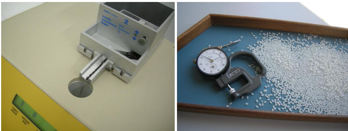
Figura 2 – Contasemi e micrometro utilizzato per la determinazione dello spessore del granello
