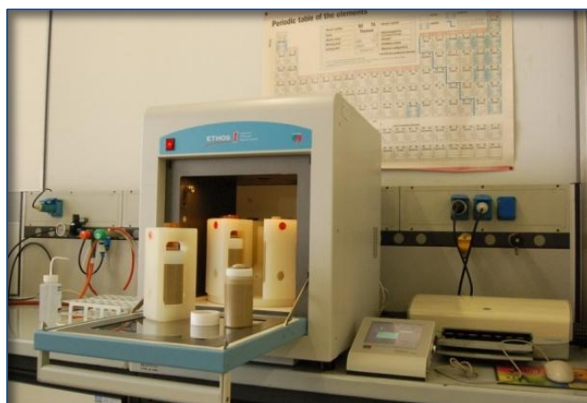
Figura 25 - Forno a micro onde per la mineralizzazione
