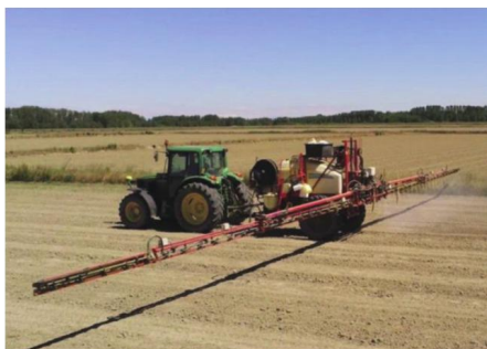
FIGURA 2 - Per la distribuzione è stata impiegata un'irroratrice Bargam Elios 2700 con barra da 24 m e 24 aperture indipendenti, accoppiata ad una trattore John Deere 6230 equipaggiata con guida automatica John Deere GreenStar Gen 4 con precisione SF 3 (+/- 3 cm)
